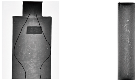
(a) 两端受阻收缩试样 X 光图, 白亮色缩孔缩松如黑线所示呈梨形分布 (b) 自由收缩试样 X 光图, 白亮色缩孔缩松呈随机分布
