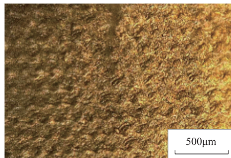
(d) 超声振动辅助钻削 ( f=30\text{mm/min} , v=0.628\text{m/s} )
