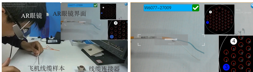
(a)使用 AR 眼镜识别线缆编码 (b)AR 眼镜软件界面
