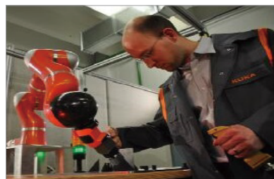
(c) KUKA iiwa 协作机器人拖拽示教作业
