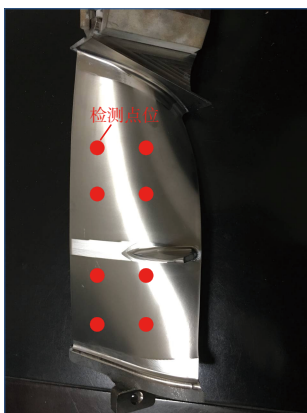
图9 叶片表面粗糙度检测选点位置
