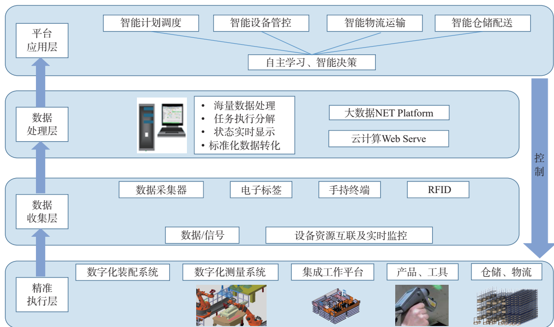
图2 飞机大部件智能装配系统总体架构
