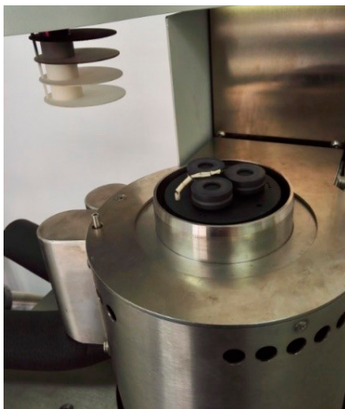
图4 热传导率试验件装样图
