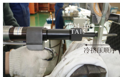
(c) 开缝衬套冷挤压孔
