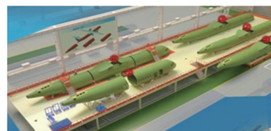
图7 飞机机身对接装配坞
