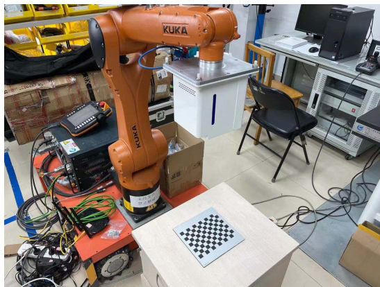
图 10 相对位姿测量系统实验室验证场景
