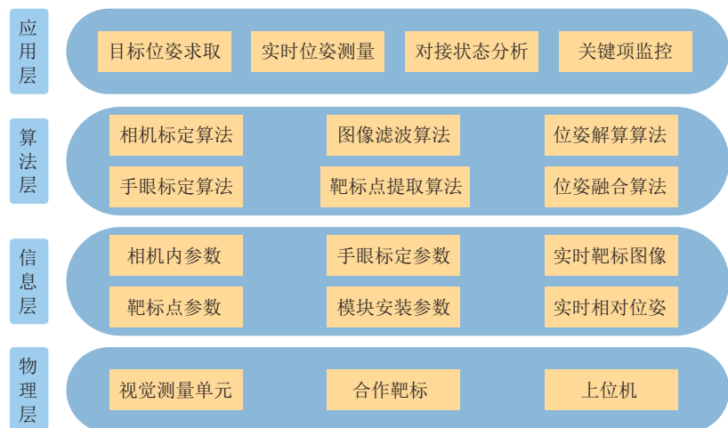
图1 基于视觉的大尺度部件相对位姿实时测量系统框架
