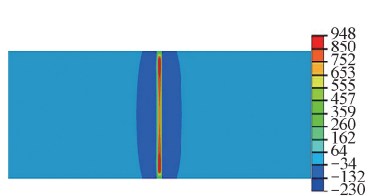
(c) 接头3: 频率50Hz, 振幅2.7mm, 压力40MPa
