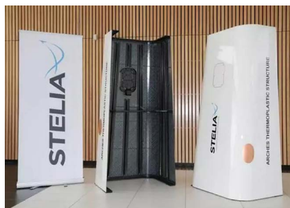
图 2 全尺寸热塑性复合材料机身验证件 Fig.2 Full-size thermoplastic composite body validation piece
