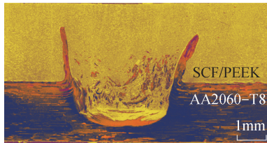
图5 SCF/PEEK与2060-T8铝合金FSLW宏观组织
