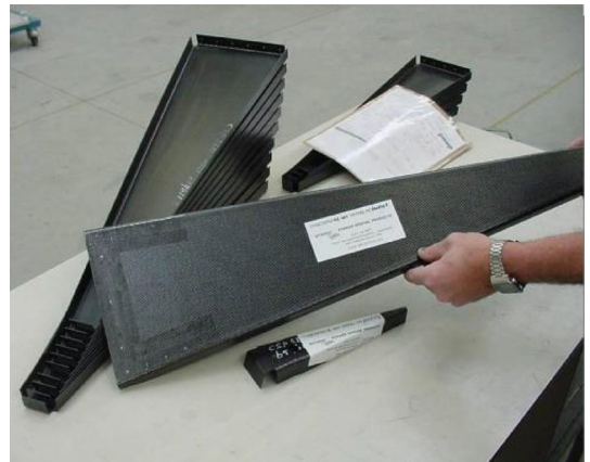
(b) 空客 A350 模压成型热塑性复材零件
