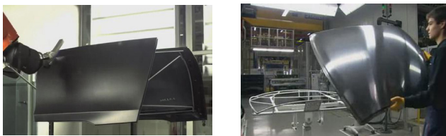
(a) 热塑性车门 (b) 热塑性引擎盖
