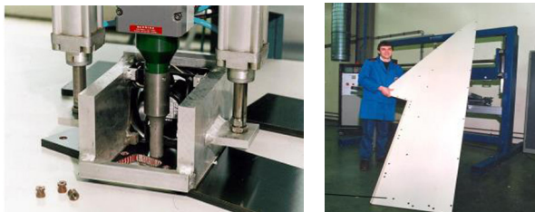
(a) 超声焊接注塑连接件与纤维加强板 (b) 超声焊接的零件
