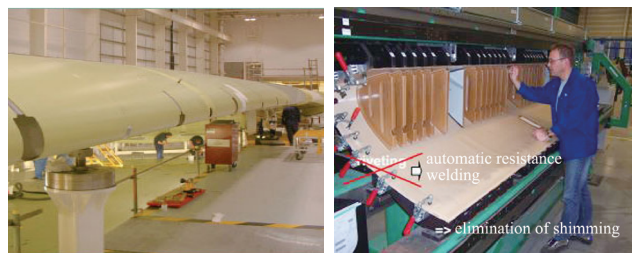
(a) 翼前缘组件 (b) 电阻焊接示意图
