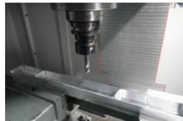
(a)长梁结构件加工现场
