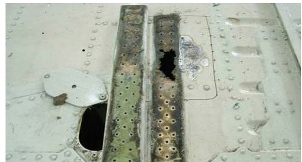
图5 严重的飞机蒙皮腐蚀
