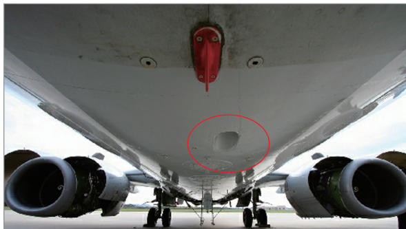
图1 飞机机身凹痕
