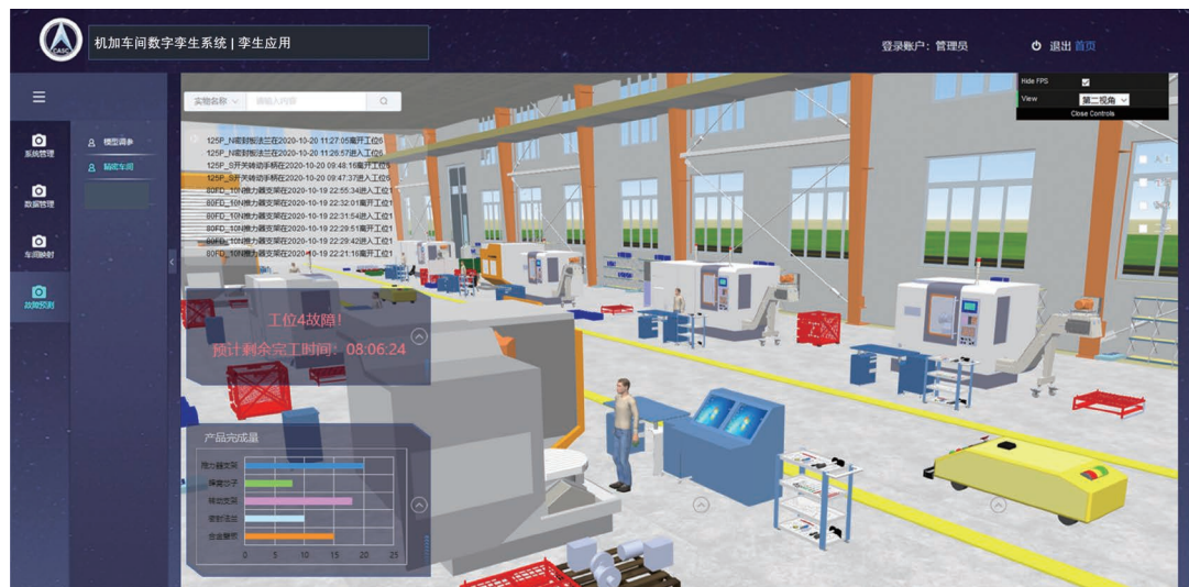
图10 基于工位状态诊断的车间资源调度
