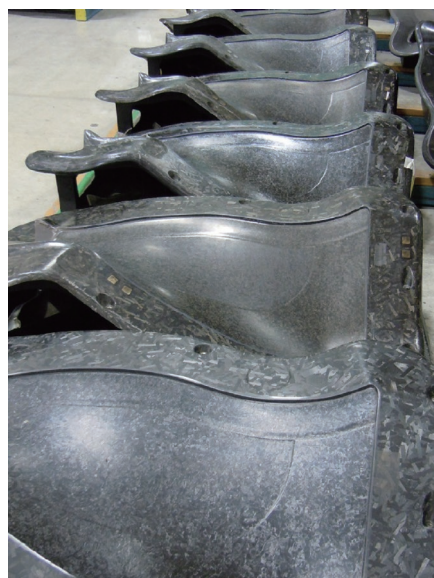
图 5 复材风扇叶片复合材料模具 HexTOOL [15] Fig.5 Composite mold of HexTOOL for composite fan blades [15]
