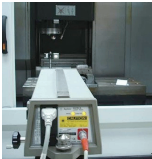
图1 用激光干涉仪测量定位误差 [14]
