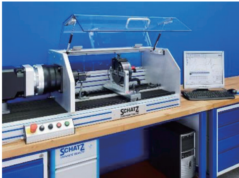
图 7 多功能螺栓紧固分析系统
