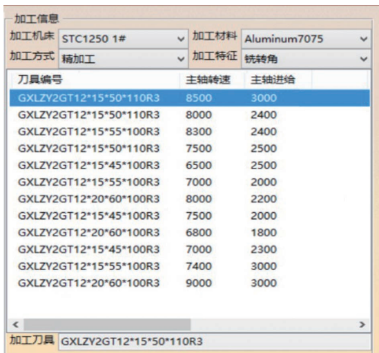
图 1 加工刀具及匹配工艺策略自动推送模块
