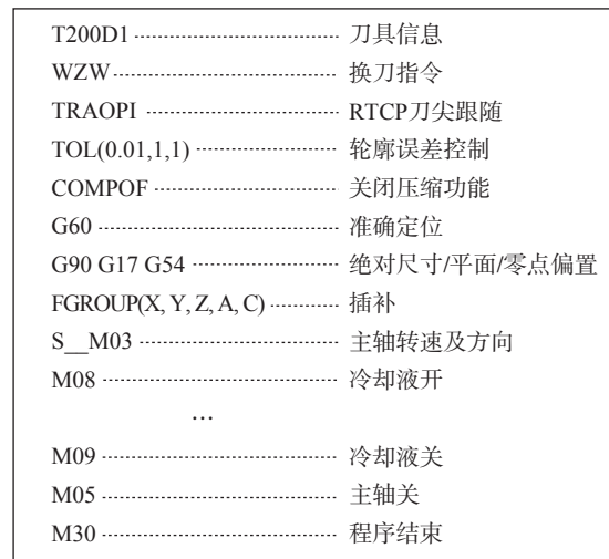
图 2 NC 加工程序标准带头带尾
