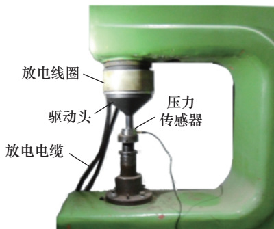
图3 电磁安装力测试平台
