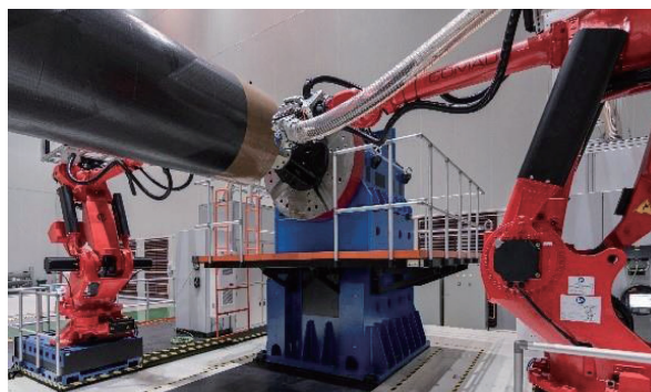
图 3 浙江大学双机器人自动铺丝系统
