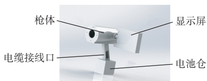
图6 手持式视觉检测设备整体效果
