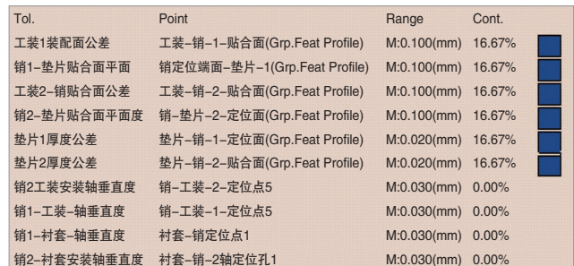
图 6 结构特征尺寸公差贡献度仿真结果 Fig.6 Result of dimension tolerance contribution simulation
