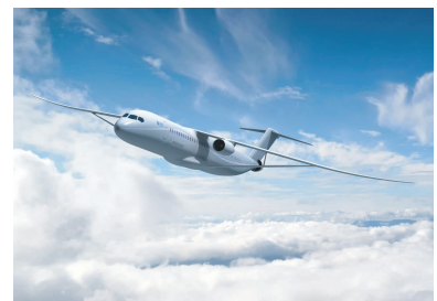
(b) NASA 的 LNG 燃料支撑翼客机概念
