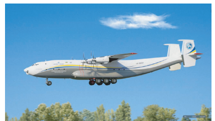
图 11 苏联 An-22 共轴对转桨扇推进运输机 Fig.11 Coaxial reverse rotating prop-fan An-22 airliner of USSR
