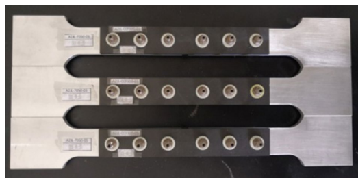
图 7 内锥衬套高锁螺栓接头试件 Fig.7 Sleeve taper-hi-bolt joints
