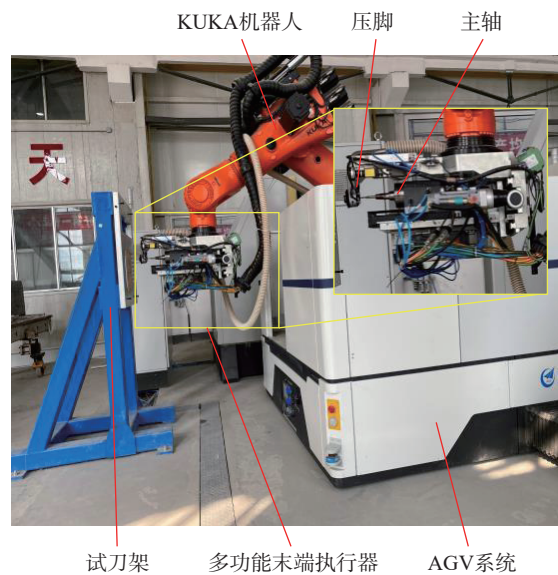
图1 机器人自动加工系统 Fig.1 Robot automatic drilling system
