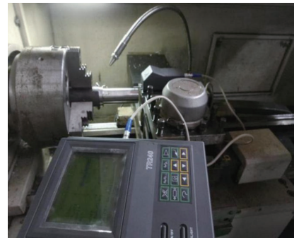
图 8 TR240 便携粗糙度仪测量表面粗糙度
