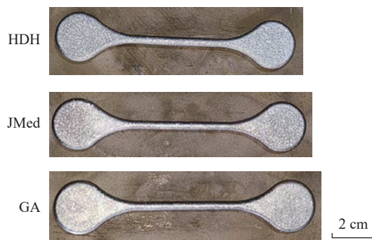
(a) 1300 °C 烧结 2 h 后 3 种 TC4 钛合金粉末烧结件外观
