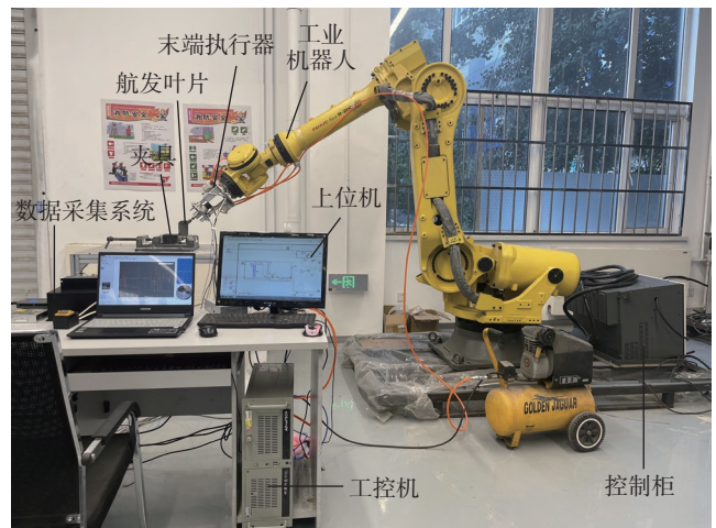
图8 航空发动机叶片机器人磨抛试验平台
