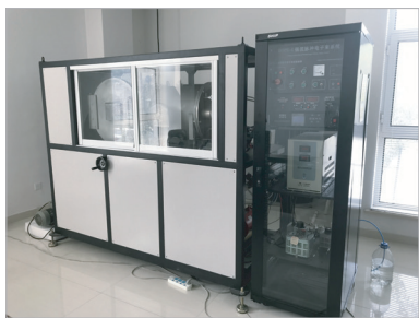
图 10 HOPE-I 型 HCPEB 装备 Fig.10 HOPE-I HCPEB system
