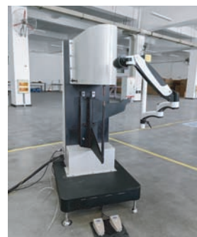
图11 立式专用电磁铆接设备
