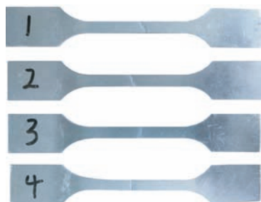
图10 不同应变率下2024-T6铝合金拉伸失效特征
