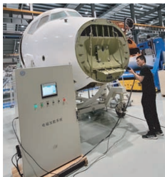
图9 国产轻量化手持式电磁铆枪
