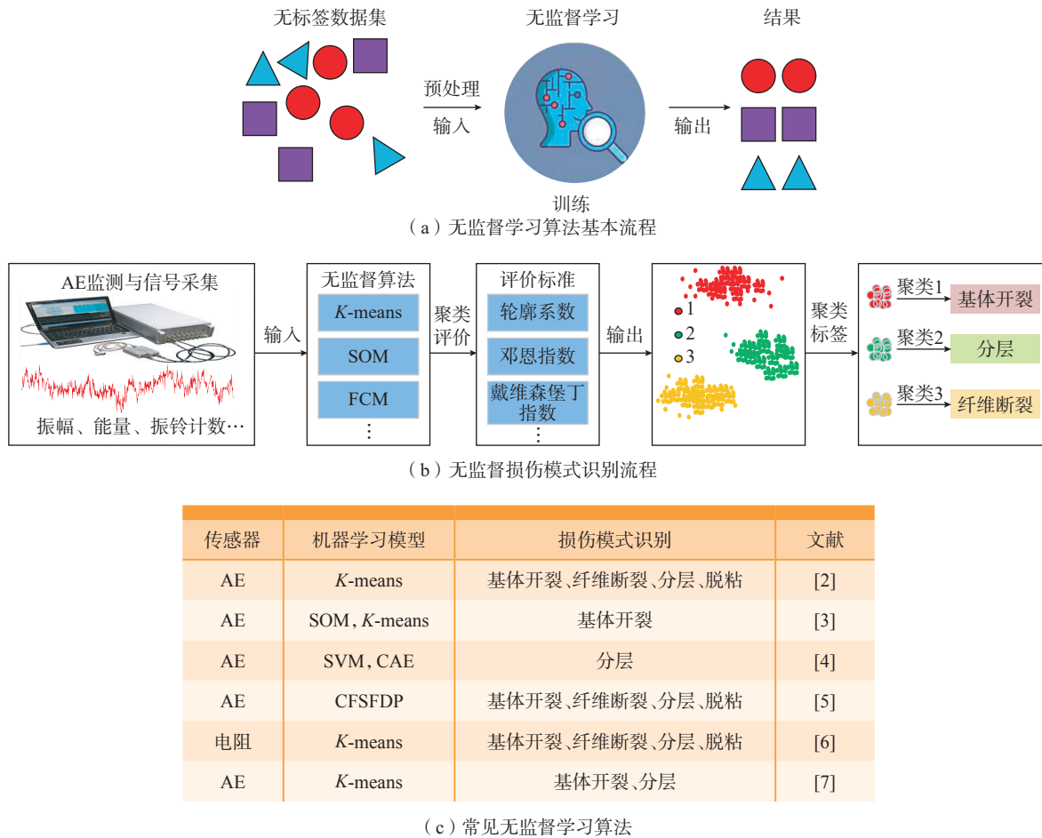
图 1 无监督学习算法步骤及基于无监督学习算法的损伤模式识别流程
