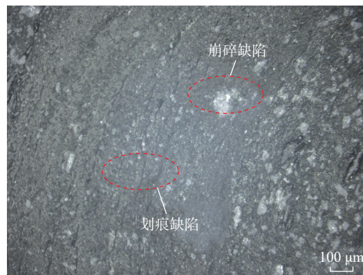
图4 大尺寸磨粒磨头产生的加工缺陷
