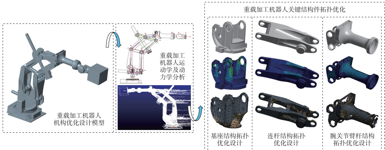
图3 大构件加工机器人轻量化设计
