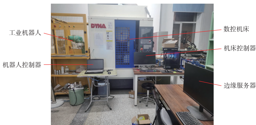
图 12 试验平台硬件总体组成
