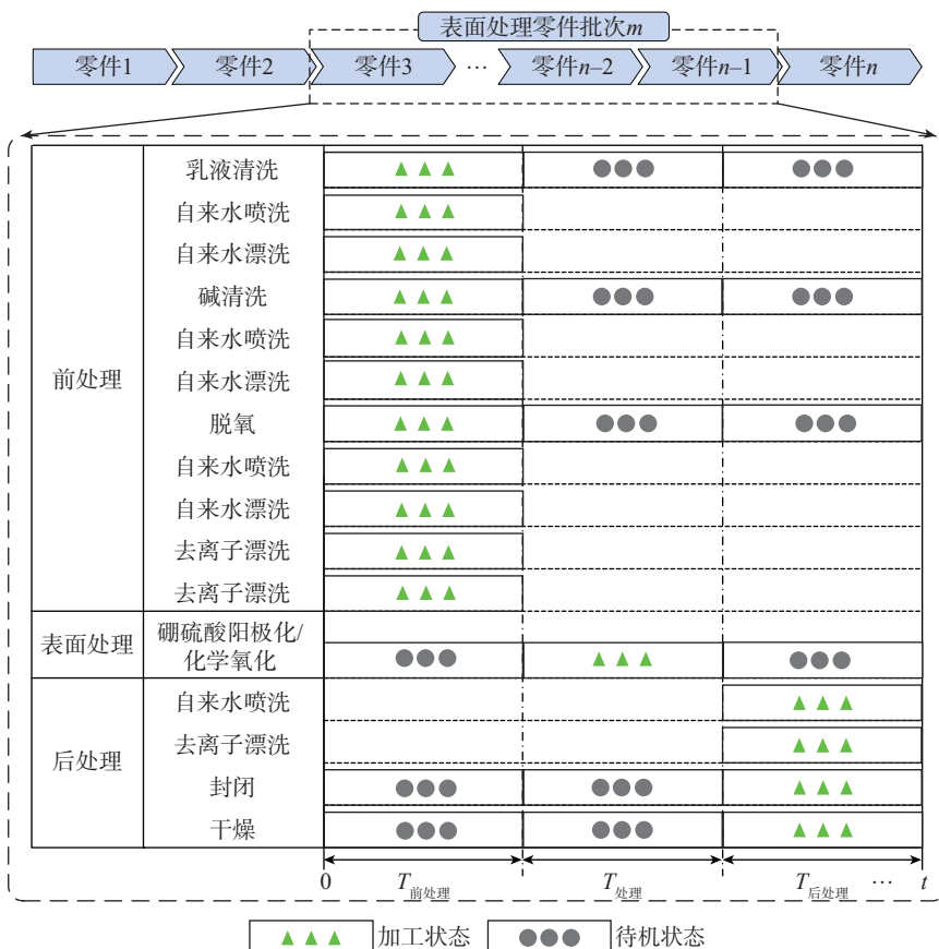
图2 考虑多碳排放源、多加工阶段、多运行状态的表面处理工艺时序耦合图
