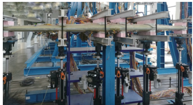
图5 水平尾翼静力试验
