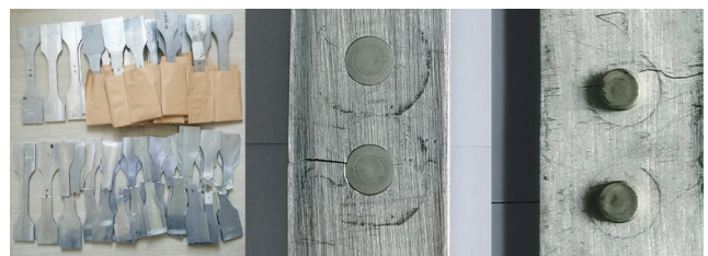
图 13 疲劳样件断裂形式
