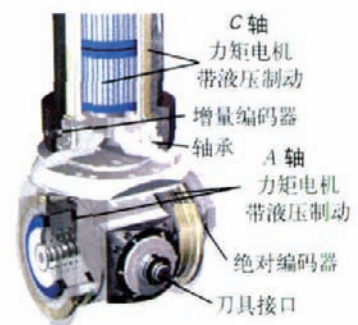
图 3 力矩电机直接驱动双摆头主轴
