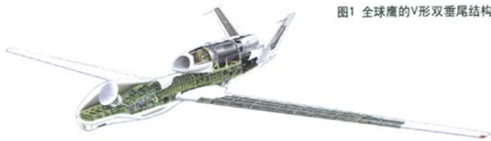
图1 全球鹰的V形双垂尾结构
