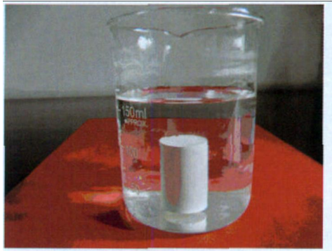
图6 丙酮对水溶性芯模的作用
