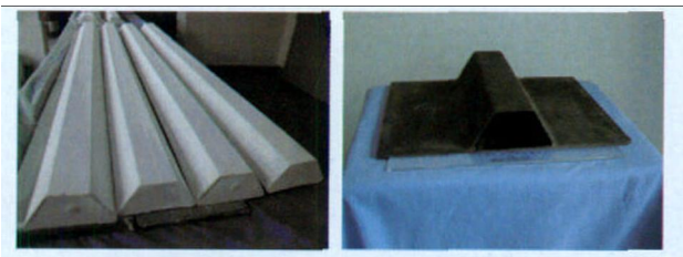
图8 采用水溶性芯模材料制备的复合材料帽形材
