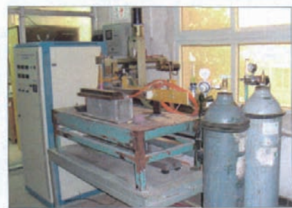
图2 新型HPVP-TIG焊接试验平台
