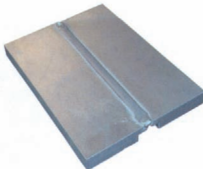
(b) 样件 2 (施焊部位厚度 9mm)
