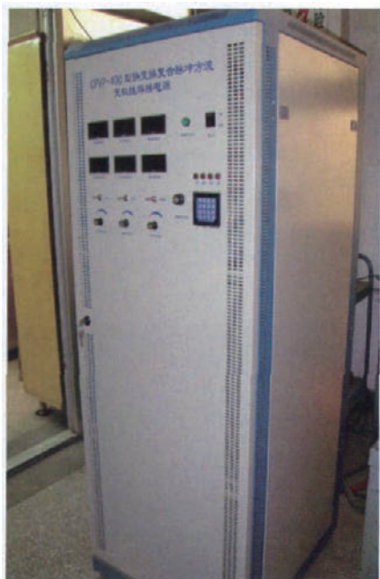
图1 新型快速变换复合超音频脉冲变极性电源原理样机
