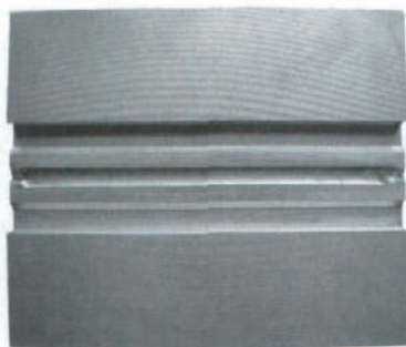
(a) 样件 1 (施焊部位厚度 3mm)
