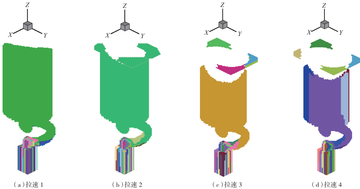
图9 单晶叶片试件凝固约60%时晶体生长界面形状和晶粒形核
