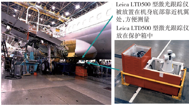
图10 Leica激光跟踪仪在机翼机身对合工装中的位置
