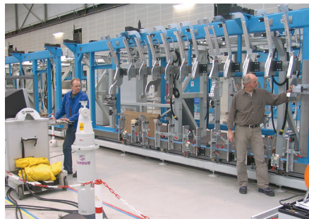
图3 Leica LTD500 型跟踪仪辅助测量装配型架
