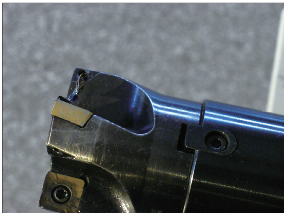
图3 钛合金插铣过程粘刀现象
