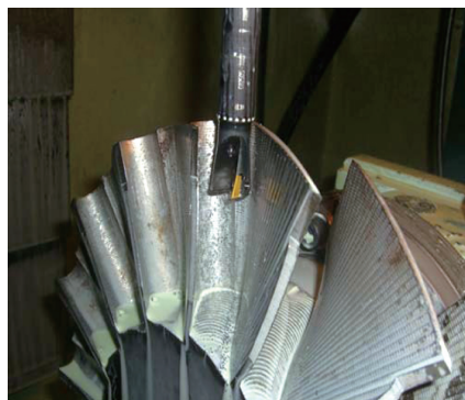
图2 开盘式叶片的插铣加工
