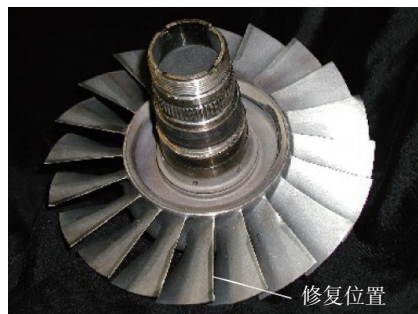
图5 LENS技术修复的黑鹰直升机叶轮上的叶片
