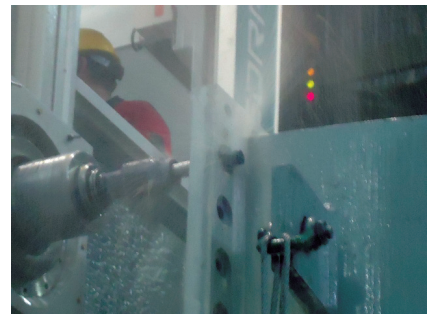
图7 反刮刀在3m高孔处开始全自动反刮切削
