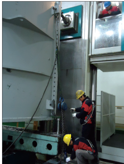
图3 反刮刀在3m高孔处全自动反刮现场
