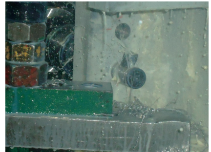
图6 反刮刀通过冷却液压力打开刀夹
