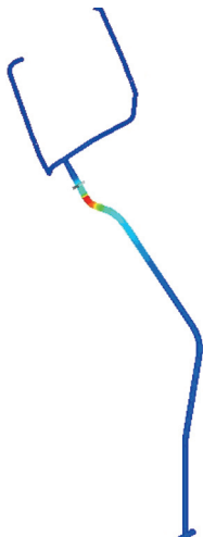
图2 光管应力云图
