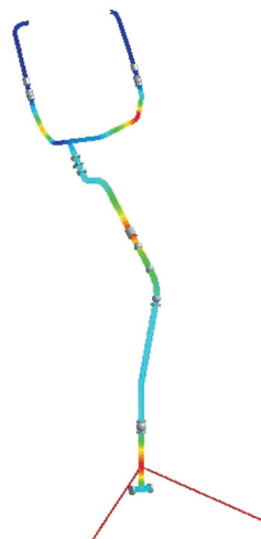
图5 添加补偿器后应力云图
